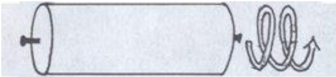
Fig. 7 Sens du déplacement hélicoïdal d'un cylindre de Componium.
