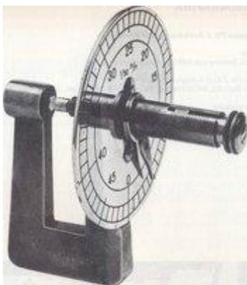
Micromètre de construction autrichienne (début XXe siècle)
