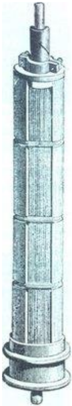
Fig. 4. - L'induit «navette» de Siemens, 1856.
