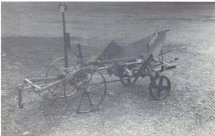
Fig. 1. - Charrue brabant-double, de la firme Mélotte (c. 1920). L'outil est posé sur un train de roues amovible pour le transport sur route. N° 76.
