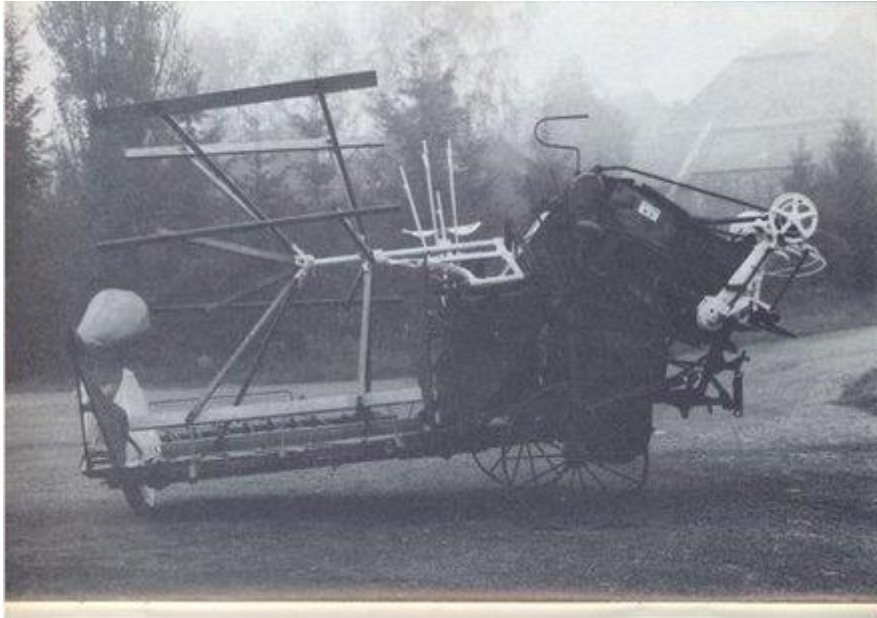
Fig. 2. - Moissonneuse-lieuse, de la firme McCormick (c. 1935), modèle "coupe à droite ". N° 5.
