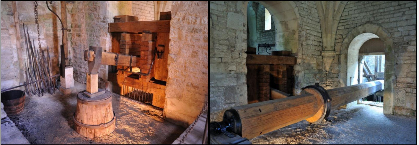
Au XIIème siècle, l'arbre à cames, entraîné par la roue du moulin, permettait d'actionner le martinet. Photos Abbaye de Fontenav 5
