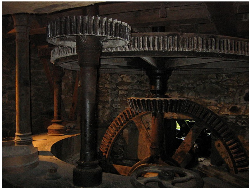
Engrenages d'une meule à grains dans un moulin à eau
