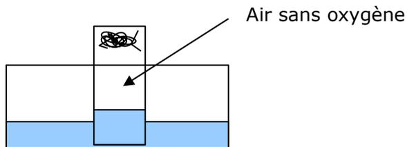
Au fil du temps, l'eau va monter dans le bocal et le fer va rouiller.
